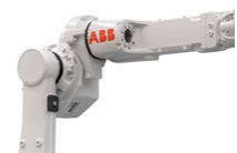
Capacità di carico: 6 kg Sbraccio: 1.55 m
